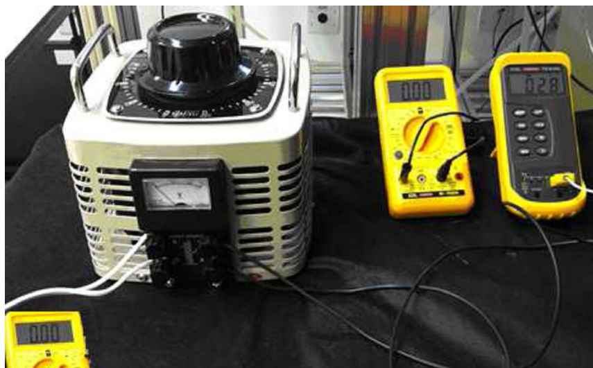
Figura 9 – Variac, multímetros e equipamento de leitura de temperatura
